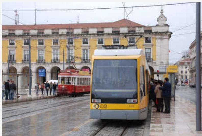
▲ Centre ville. A gauche : motrice du circuit touristique régulier avec stationnement sur voie dédiée. A droite : motrice articulée de la L 15 vers Belem. ▼ A remarquer un passage de gauche à droite pour respecter le rayon de courbure (boucle terminus central).
